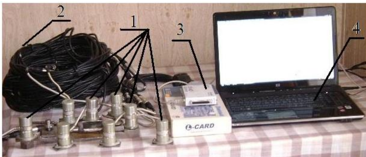
Рисунок 2 – Мобильный виброизмерительный комплекс: 1 – вибродатчики МВ-25Д-В; 2 – соединительный кабель; 3 – многоканальный АЦП Е14-440; 4 – портативный компьютер типа «NoteBook»
