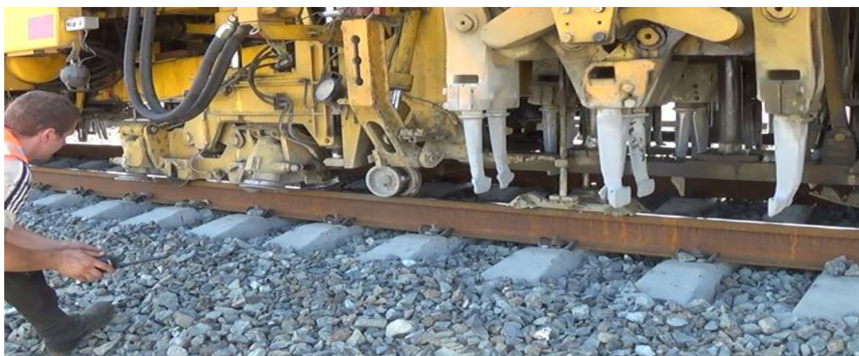
Рисунок 1 – Машина DUOMATIC 09-32 CAT
