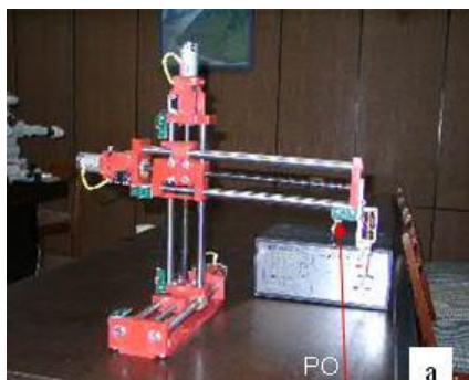
Рисунок 1 – Роботы в прямоугольной (а) и цилиндрической (б) системах координат
